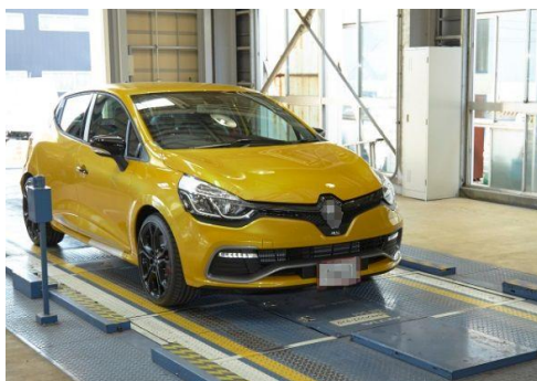
サイドスリップテストによる検査風景
