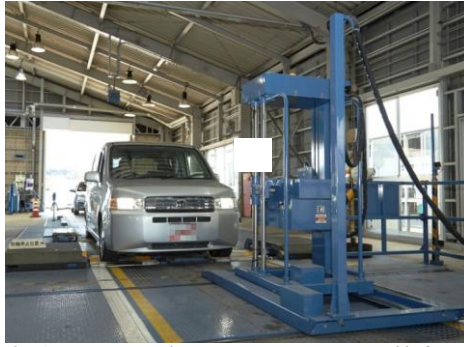
すれ違い用ヘッドライトテストによる検査風景
